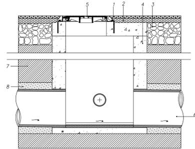
**Dettaglio sezione pozzetto stradale 1/20**
