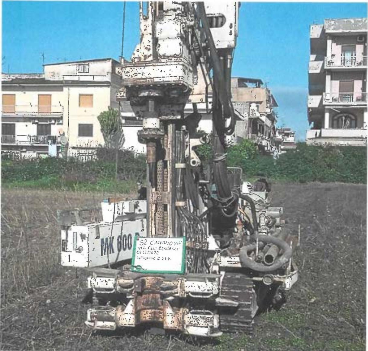
Foto 1: Sonda utilizzata nell'esecuzione dei sondaggi geognostici a carotaggio continuo.
