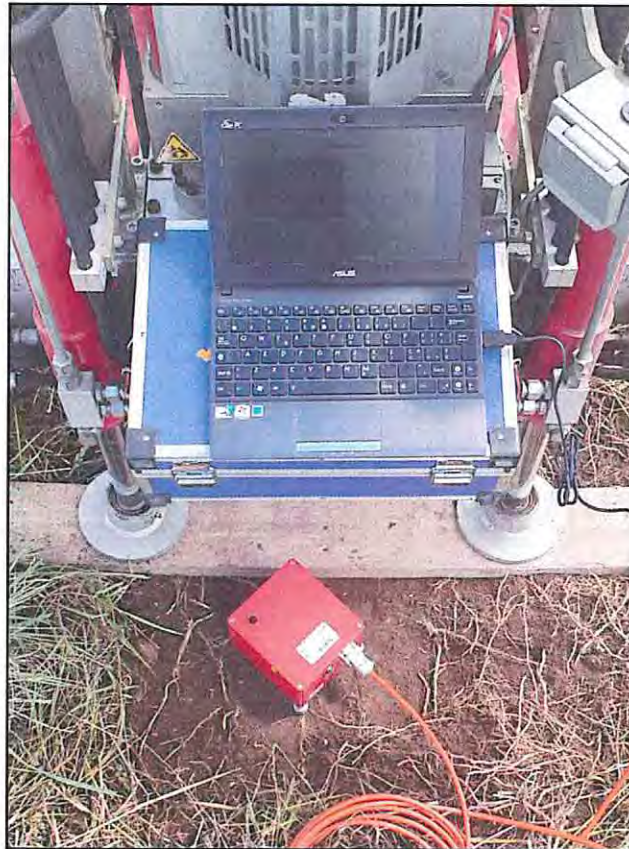
Fig. 4 sismografo digitale modello "SR04 GeoBox" in registrazione
