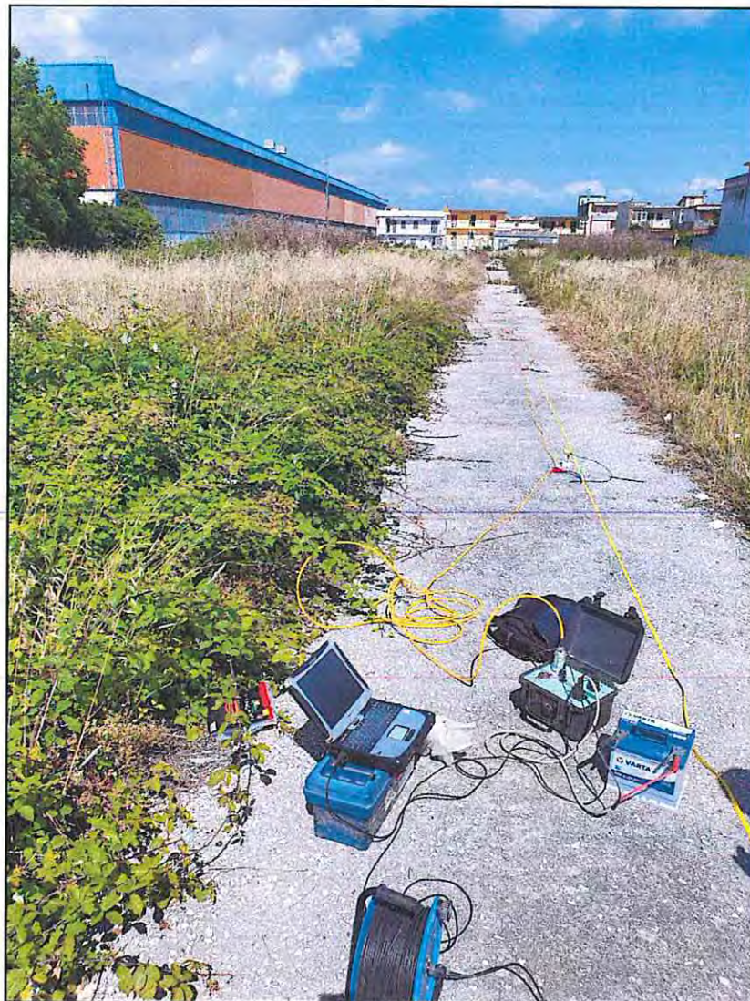
Fig. 11 – foto acquisizione sismica MASW (componente radiale onde di Rayleigh)
